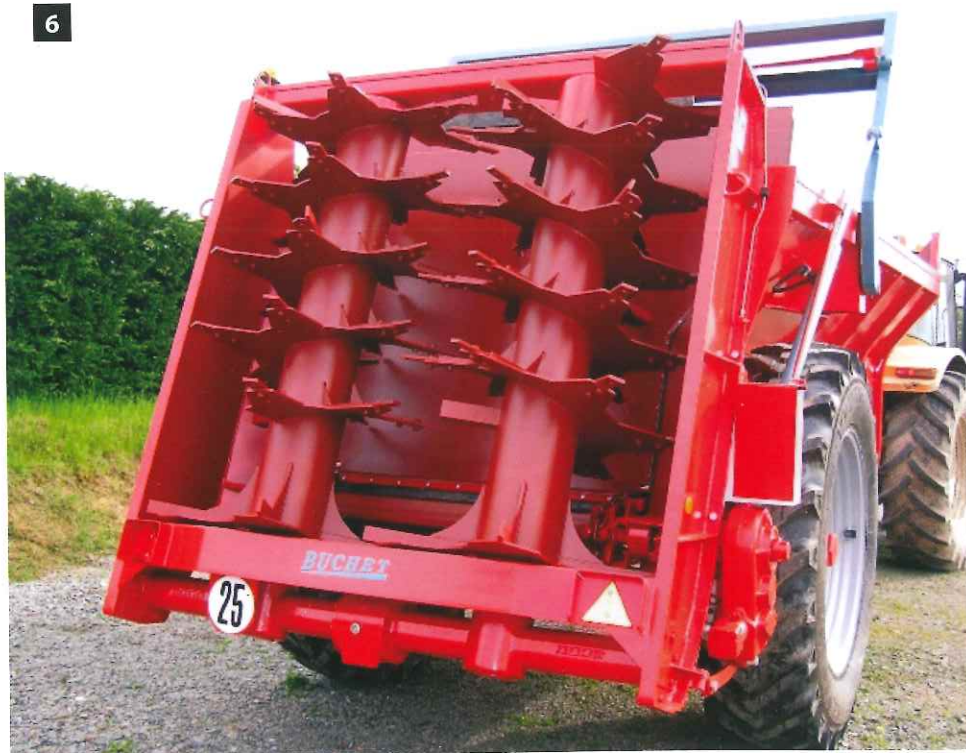
Fig. 6 : Épandeur à deux hérissons verticaux.
