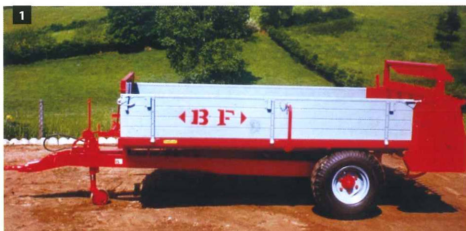
Fig. 1 : La remorque basculante multifonction équipée en épandeur.
