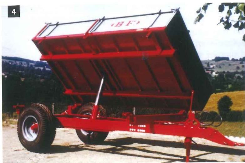
Fig. 4 : Remorque basculante tri-benne.
