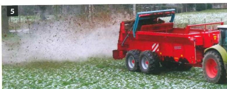
Fig. 5 : Épandeur à double essieux.
