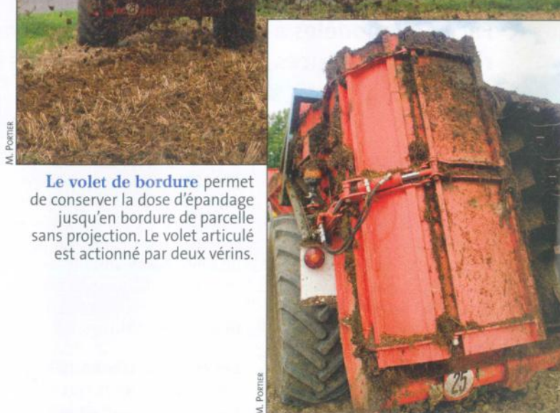
La caisse évasée, le tablier accompagnateur, la porte à double bras et les hérissons très inclinés caractérisent l'épandeur Buchet.
