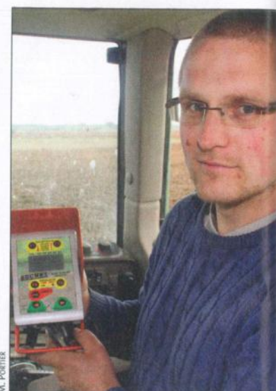
Damien Gruson. « Le boîtier permet de piloter l'ensemble des fonctions de l'épandeur. Avec la pesée, il suffit d'indiquer le dosage et la largeur de travail. »
