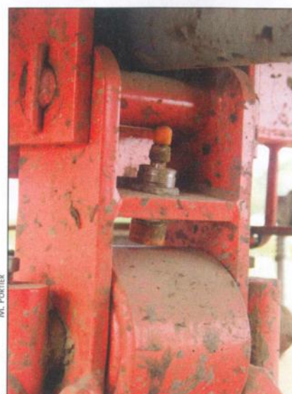
Le système de pesée fonctionne avec un seul capteur sur la flèche, ce qui limite sa précision.
