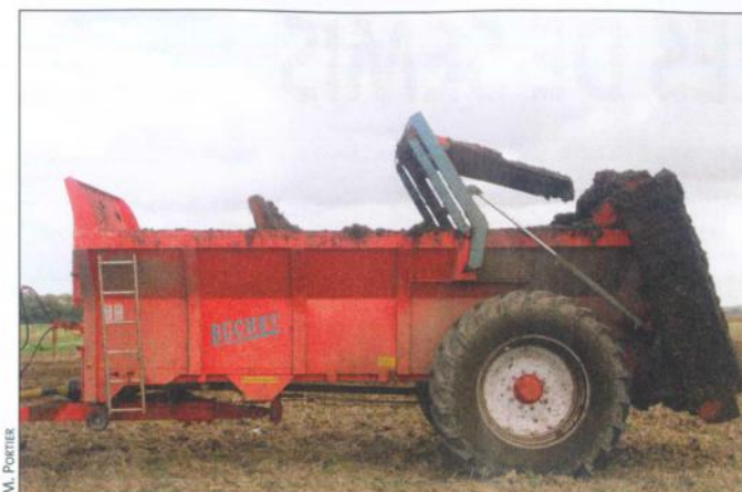
La caisse évasée, le tablier accompagnateur, la porte à double bras et les hérissons très inclinés caractérisent l'épandeur Buchet.
