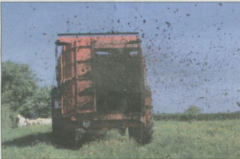
L'épandeur à tablier Buchet offre une grande régularité d'épandage grâce à une combinaison d'innovations que sont : le tablier, le DPA et le pesage du fumier.
