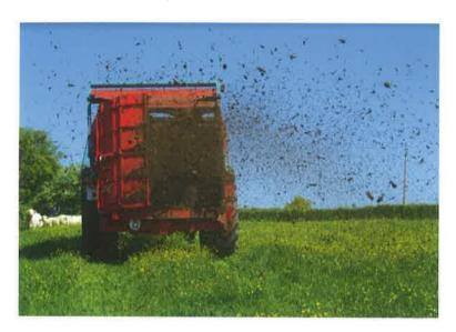
Volet de bordure en action: le système de régulation permet de maintenir le dosage/hectare programmé même lorsque le volet de bordure entre en action.
