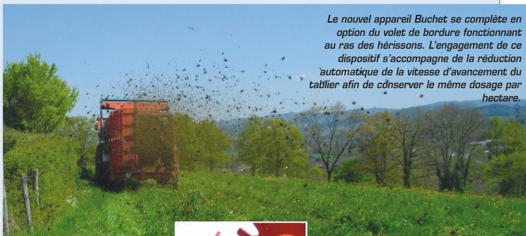
Le nouvel appareil Buchet se complète en option du volet de bordure fonctionnant au ras des hérissons. L'engagement de ce dispositif s'accompagne de la réduction automatique de la vitesse d'avancement du tablier afin de conserver le même dosage par hectare.
