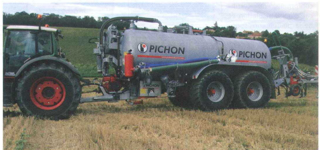
Patrice Vergnes, entrepreneur de travaux dans l'Aveyron, été le premier à s'équiper d'une combinaison certifiée : une tonne de 18 500 litres, avec enfouisseur et rampe à pendillards pour épandre lisiers et boues d'épuration.
