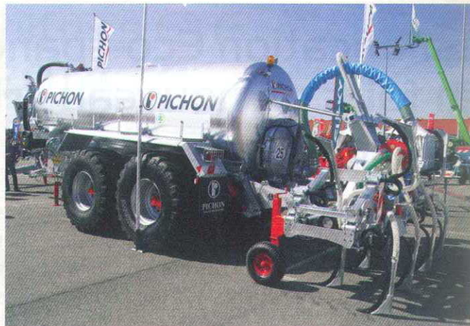
Chez Pichon, l'assemblage n°P002 est notamment constitué d'une cuve de 15 700 litres montée sur un train roulant à pneumatiques larges (650/60R26,5), et d'un dispositif enfouisseur à 11 dents travaillant sur 5 m de largeur.
