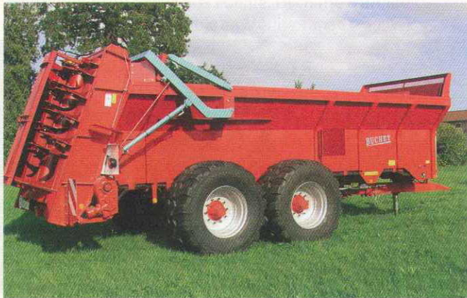
Buchet a déjà certifié trois épandeurs EHV de 12 à 14 m 3 . Ils disposent d'un tablier accompagnateur, et de hérissons associant couteaux et marteaux. Le quatrième modèle de 18 m 3 arborera sous peu le logo Éco-épandage.
